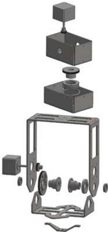
Figure 2. Visão explodida do suporte com movimentação para as câmeras.
