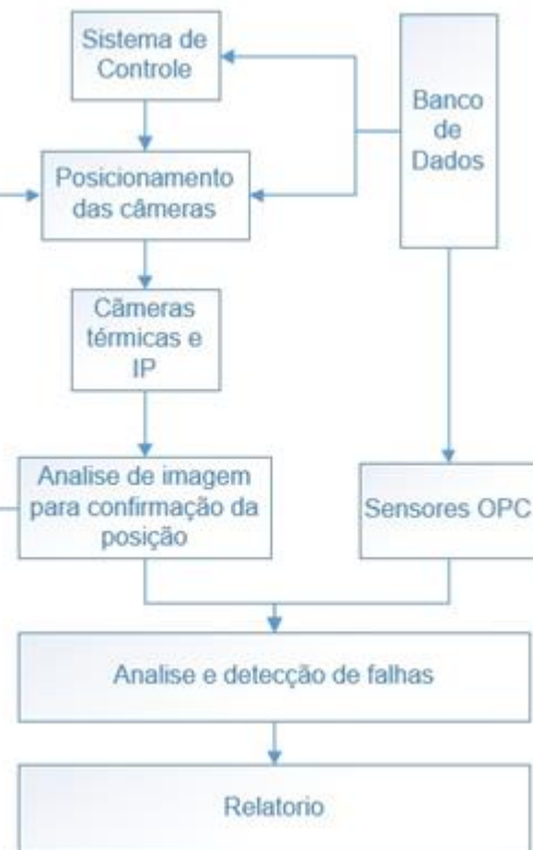
Figure 1. Visão geral do sistema inteligente de monitoramento.
